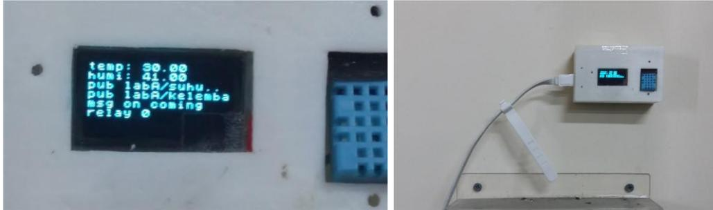
Gambar 3. ESP32 di dalam Lab Komputer “labA”
