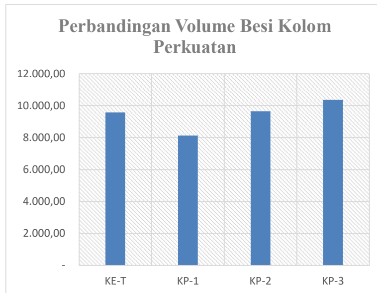
Gambar 8. Perbandingan Volume Besi Kolom Perkuatan dengan Eksisting
