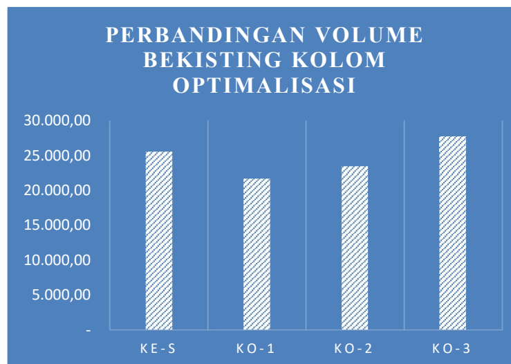
Gambar 11. Perbandingan Volume Begisting Kolom Optimalisasi dengan Eksisting
