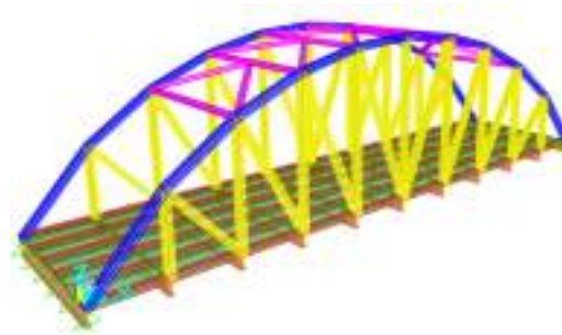
Gambar 2. Pemodelan Struktur Rangka Jembatan tipe Camel Back pada aplikasi SAP2000 V22
