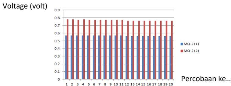
Grafik 3.2. Grafik percobaan vs pembacaan *voltage* sensor dengan udara normal
