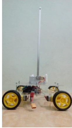
Gambar 4 Bentuk prototype dari inverted pendulum
