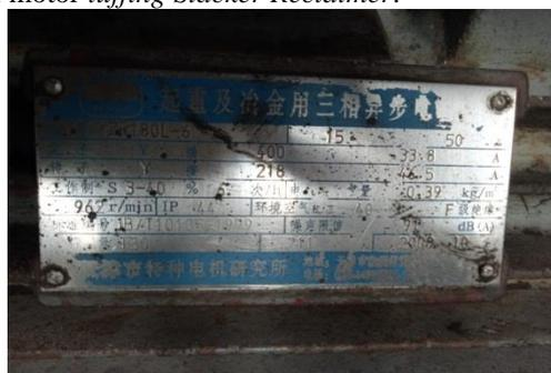
Gambar.7 Spesifikasi Motor *Luffing Stacker Reclaimer*
