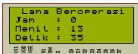
Gambar 14. Tampilan lama operasi motor listrik pada LCD.
