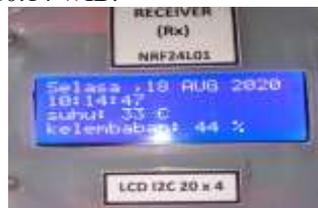
**Gambar 10.** Tampilan LCD 20x4 di modul *receiver NRF24L01*
