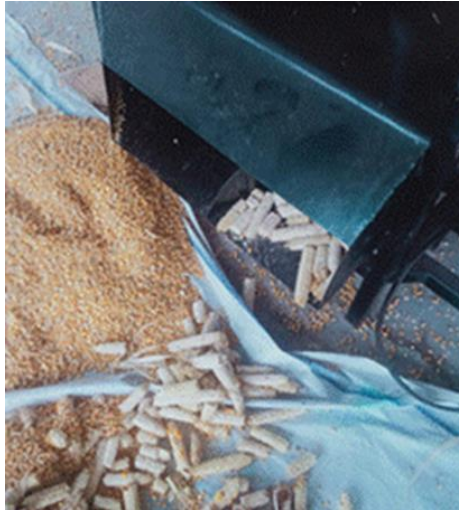
Gambar 7. Hasil pemisahan biji jagung dari tongkolnya dengan mesin pengupas kulit-pemipil jagung
