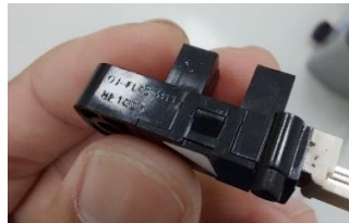
Gambar 4. Sensor pada motor rollback Printer DR Carestream 5700
