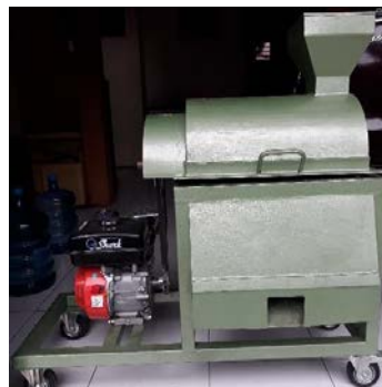
Gambar 5 alat pemipil jagung dengan penggerak motor bakar
