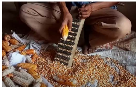
Gambar 1 alat pemipil jagung sederhana dengan karet ban
