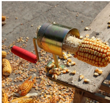
Gambar 2 alat pemipil jagung sederhana dengan tuas
