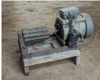
Gambar 3 alat pemipil jagung sederhana yang ada di desa karanganom
