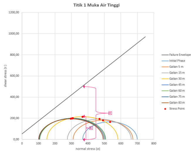
Gambar 11. Kondisi Perbandingan Titik Pantau 1 Muka Air Tanah Tinggi
