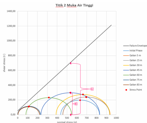
Gambar 13. Kondisi Perbandingan Titik Pantau 2 Muka Air Tanah Tinggi
