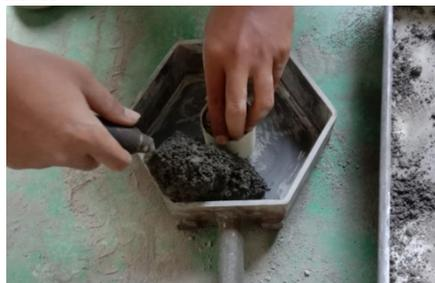
Gambar 2. Pencetakan *Paving Block*
