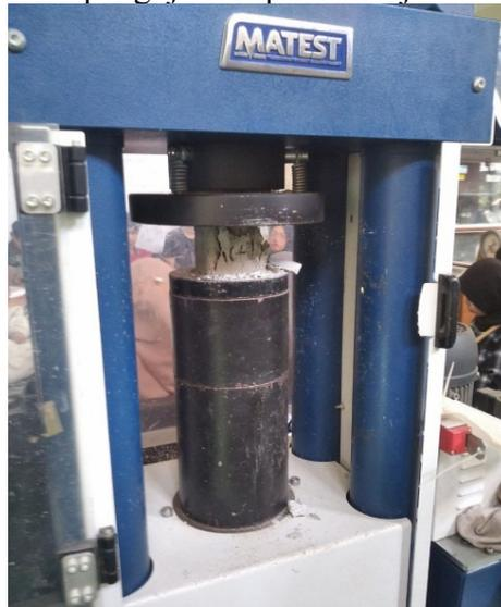
Gambar 4. Proses Pengujian Kuat Tekan
