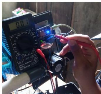
Gambar 14 Arus beban Mikrokontroler NodeMCU ESP8266 pada *Water Flow* Sensor
