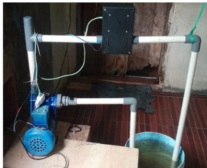
Gambar 7 Pengukuran debit dalam pengisian air.
