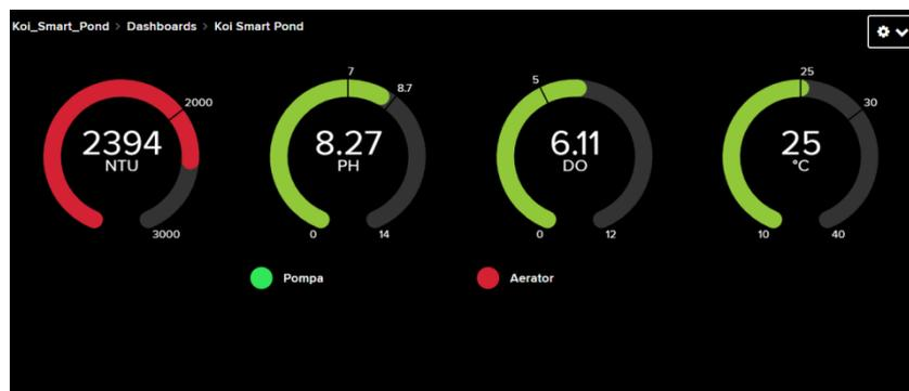
Gambar 12 Tampilan adafruit.io pada kadar kekeruhan tinggi
