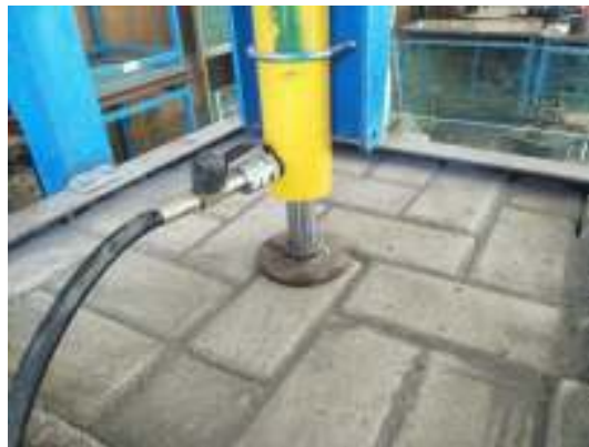
Gambar 6. Sebelum diberi gaya vertical pada paving holland
