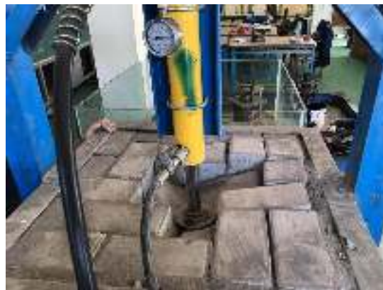
Gambar 5. Paving block setelah di uji
